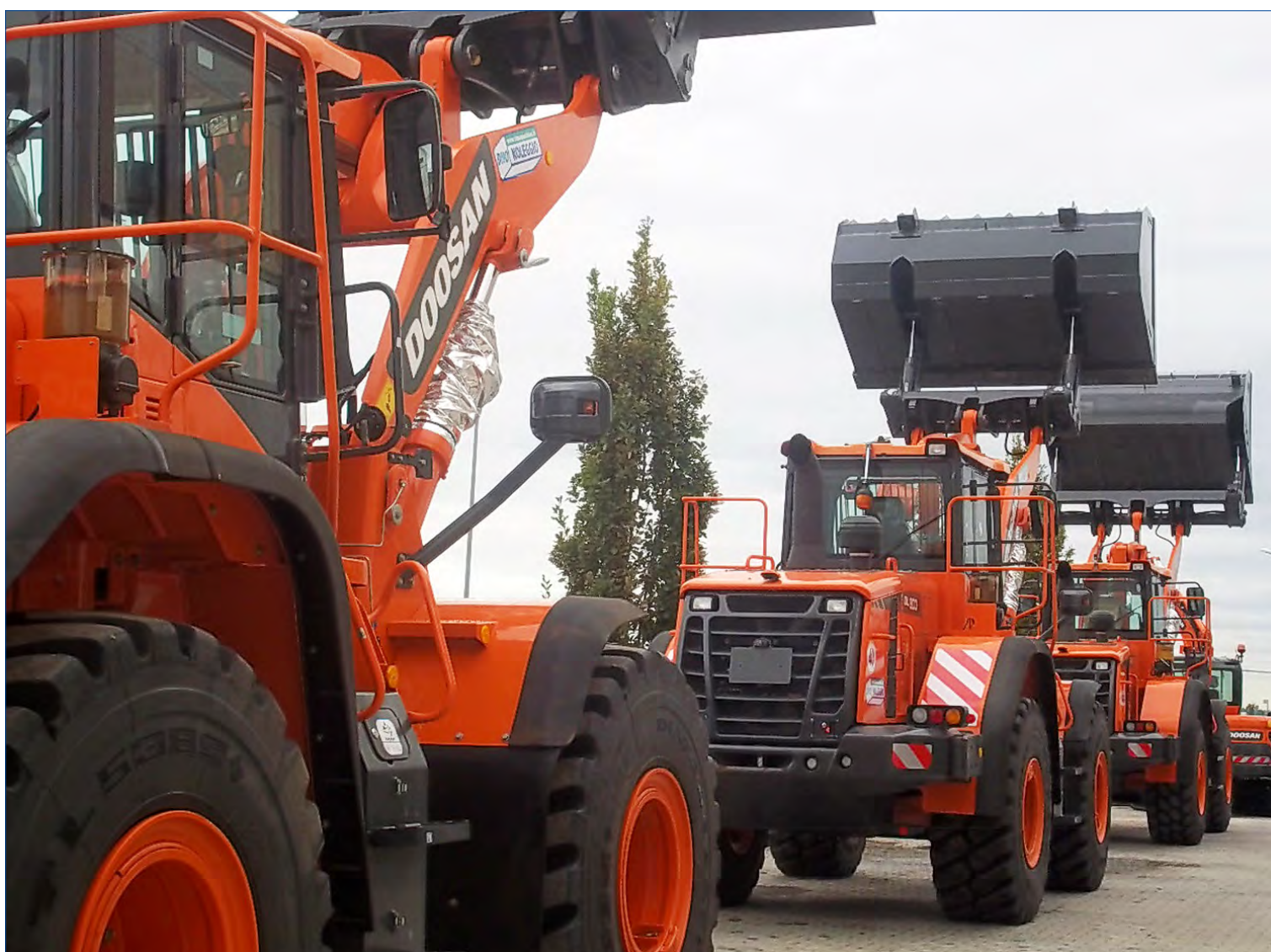
PALE GOMMATE DOOSAN DL 200-5 DL 250-5 DL 300-5: benna a scarico alto con griglia alta visibilità, gomme rinforzate, sistema di pesatura del carico, griglia protezione cabina, pressurizzazione cabina con carboni attivi.
