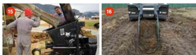
Le pale compatte serie R Bobcat sono dotate di impianto idraulico ad alta portata o Super Flow per migliori prestazioni con accessori avanzati.
