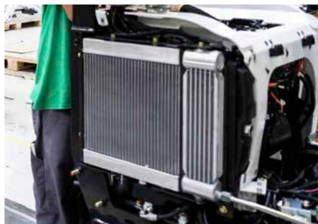
Scambiatore di calore dell'olio idraulico
