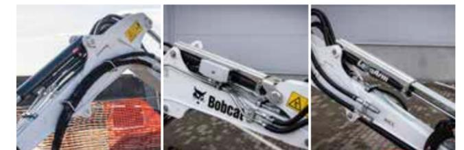
Predisposizione per pinza Copertura per cilindro benna Copertura per cilindro avambraccio
