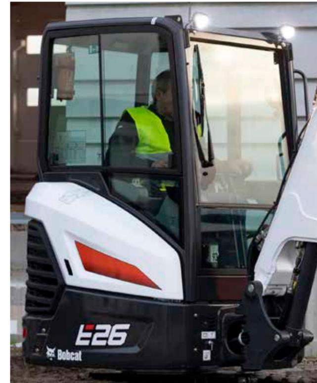
Cabina TOPS/ROPS/FOPS con riscaldamento
