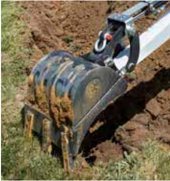
Benna da scavo
