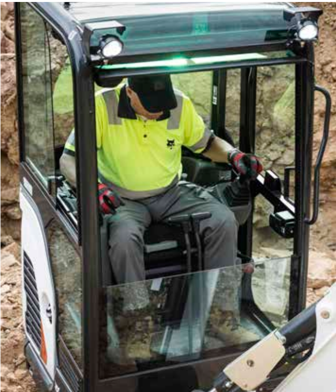
Cabina TOPS / ROPS con impianto di riscaldamento
