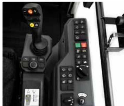
Tutto, dal joystick alla console con i pulsanti, senza dimenticare il comando jog, è a portata di mano e progettato per la massima facilità d'uso.
