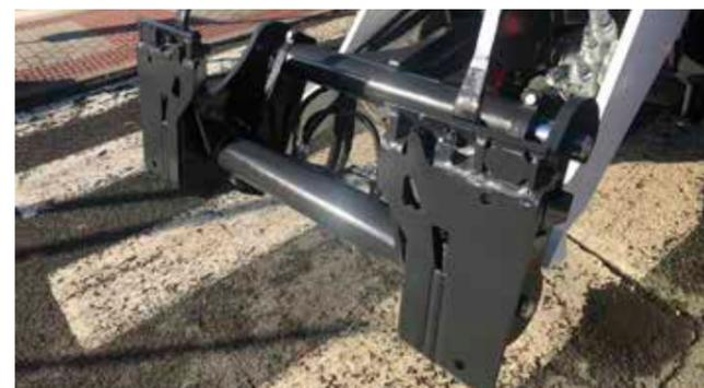
Adattatore da Quick-Tach™ a Bob-Tach™ (necessario per tutti gli accessori ad eccezione di benne e forche per pallet)
