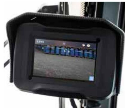
Sullo schermo LCD, controllato con il comando jog, sono visualizzate informazioni importanti sulla macchina e il display cambia automaticamente al feed della telecamera posteriore quando si inserisce la retromarcia.
