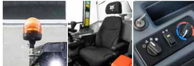
Lampeggiatore Sedile riscaldato Premium Condizionatore d'aria (climatizzatore)
